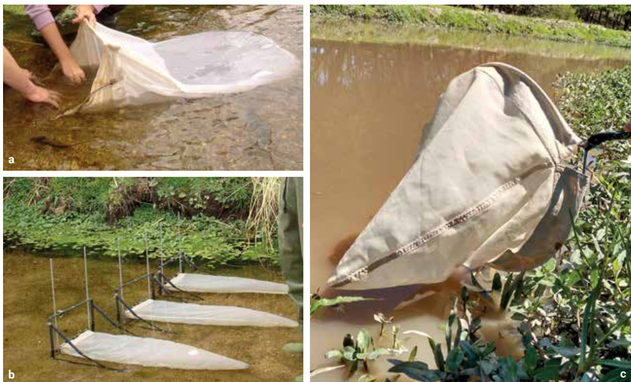
Figura 3: a) Red Surber para colectar la comunidad bentónica de macroinvertebrados. b) Redes de deriva ubicadas en el arroyo. c) Copo de mano para colectar macroinvertebrados asociados a la vegetación de las márgenes.
