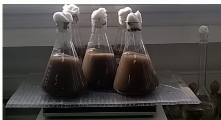
FIG. 2 - Agitación de sedimentos en agua para la preparación de elutriados.
